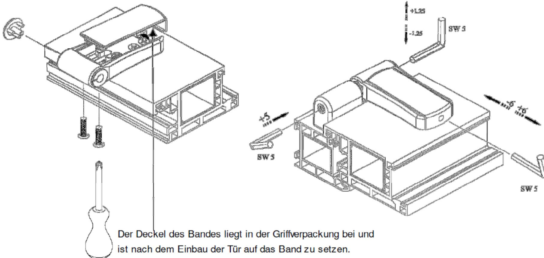
Der Deckel des Bandes liegt in der Griffverpackung bei und ist nach dem Einbau der Tür auf das Band zu setzen.
