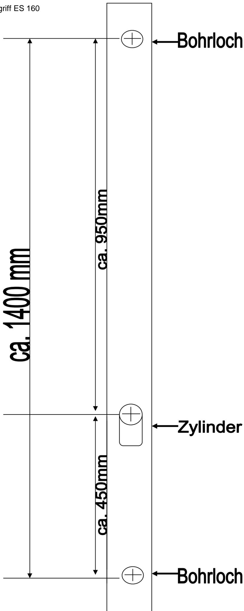
1. Zylinder in das Schloss einsetzen und verschrauben
