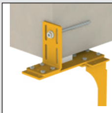
Blendrahmenstabilisierung TOP MINI plus RvU
