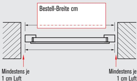
Im Anschlag montiert. Rahmenanschlag maximal 5 cm.
